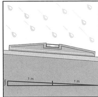
Террасные доски марки HOLZHOF шовная монтируются на лаги, которые укладываются либо на сплошное и ровное бетонное основание, либо на бетонные опорные балки, либо на любую другую ровную и твердую поверхность, покрытую материалом из искусственного волокна (геотекстиль), который препятствует прорастанию сорняков.
